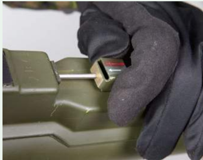
Liipaisinvarmistin poistetaan työntämällä sitä eteenpäin.
