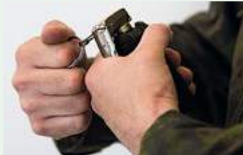
Kierrä vetorengasta takaisin päin ennen varmistussokan irti vetämistä
