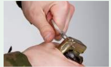
Pujota vapaana olevan käden etusormi vetorengaaseen
